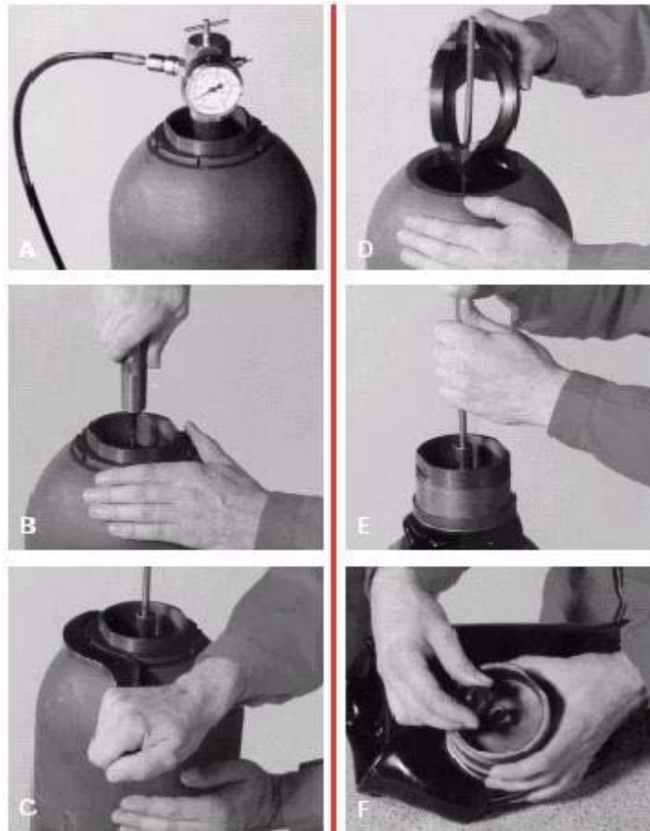
ภาพที่ 1 -41 แสดงการถอดถึงสะสมพลังงานไฮดรอลิกแบบถอดเปลี่ยนด้านบน
