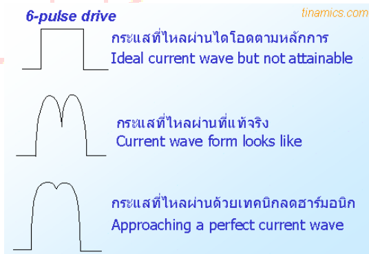
รูปที่ 4 รูปแสดงกระแส input แบบ 6 Pulse diode rectifiers
