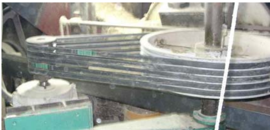
รูปที่ 6 การส่งกำลังโดยสายพานระหว่าง มอเตอร์กับโหลด
