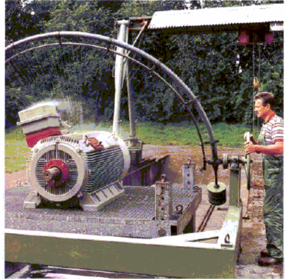
รูปที่ 4 แสดงเครื่องและการทดสอบการป้องกันน้ำ IP X6
