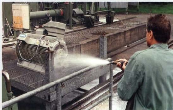
รูปที่ 5 ระหว่างทดสอบ IPx6 ด้วยการฉีดน้ำที่แรงดัน 1 บาร์ ด้วยปริมาณ 100 ลิตร/นาที
